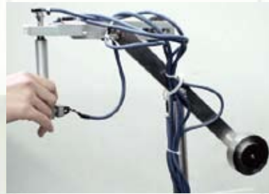
マスター・スレーブ方式のマニピュレータロボットシステムのマスター部分
